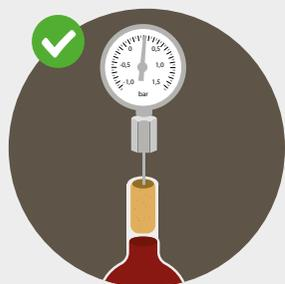
Contrôle de la dépression sur bouteille avec un aphromètre.
