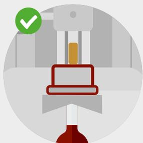
Réglage de la table de la boucheuse : la bouteille doit être à bonne hauteur, en appui contre le cône de centrage.
