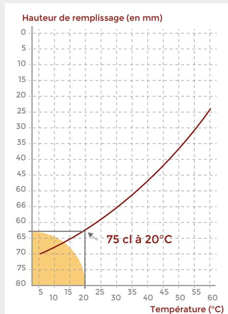
L'abaque du verrier indique la hauteur de remplissage en fonction de la température du vin.
