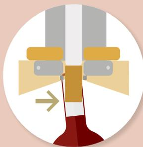
2. Le bouchon tape sur l'entrée du col et se retousse. Il descend dans la bouteille, poussé par la broche mais frotte fortement contre l'intérieur du col. La descente ne se fait pas complètement ou pas correctement.
