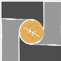
Des mors ébréchés provoquent inévitablement des coupures plus ou moins profondes sur les bouchons. Les bouchons abîmés risquent alors de présenter des défauts d'étanchéité et/ou des risques de bouteilles couleuses.
